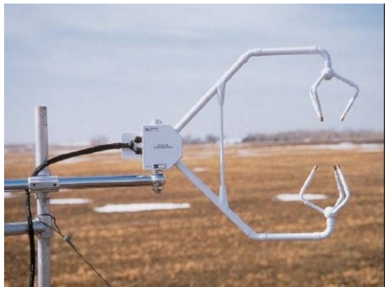
Rysunek 7: Wiatromierze wykorzystujące pomiar prędkości ultradźwięku. Po prawej model dokonujący również pomiarów w kierunkach pionowych [3].
