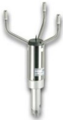
Rysunek 7: Wiatromierze wykorzystujące pomiar prędkości ultradźwięku. Po prawej model dokonujący również pomiarów w kierunkach pionowych [3].
